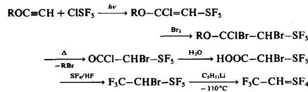
Das Trifluormethylderivat eliminiert HF praktisch quantitativ, wenn es im Gaszustand bei 50–60°C und 10<sup>-1</sup> mbar durch ein 40 cm langes Quarzrohr (12 mm Durchmesser, gefüllt mit zerriebenem, trockenem KOH) gepumpt wird.
